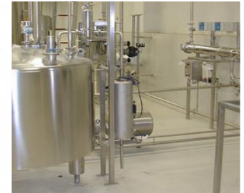
UV-Anlage zur Desinfektion und Restozonvernichtung EL-PH 052 für 6m 3 /h Türkei
